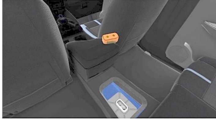
Şekil 3.5. Elektrik sistemini devre dışı bırakma
