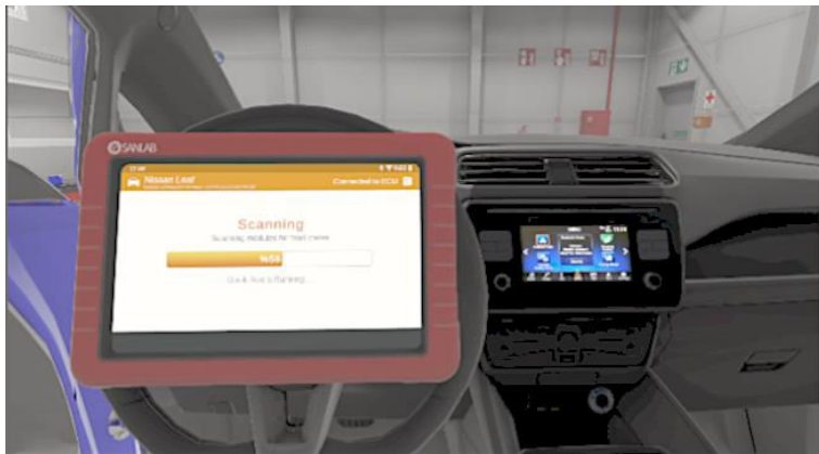
Şekil 3.4. OBD soketine cihazın bağlanması
